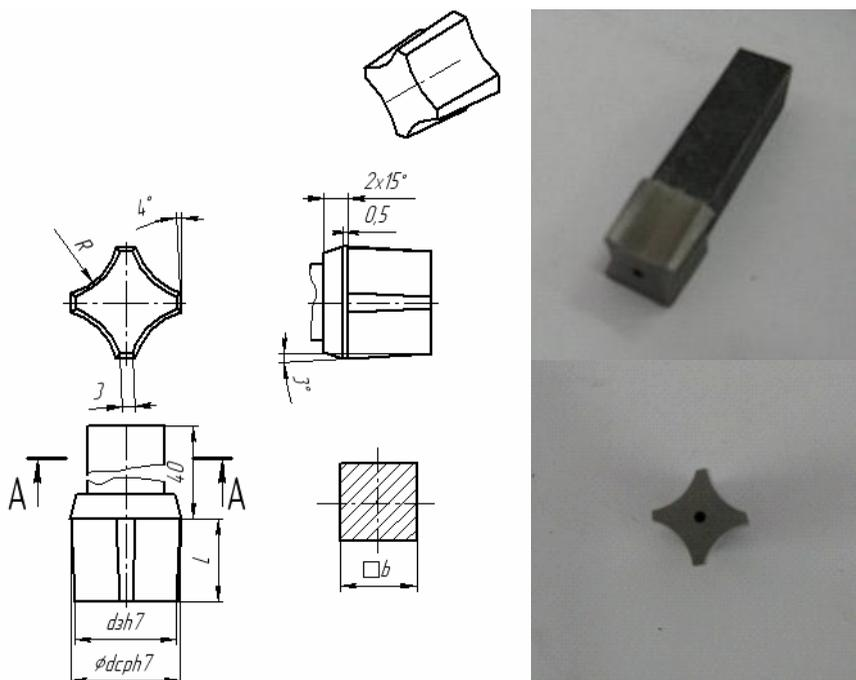
Рисунок 3 – Деформирующий инструмент для глухих отверстий
